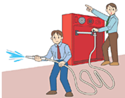
屋内消火栓設備
