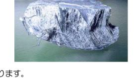
アスベストは加工しやすく、吸音や吸着性・引っ張り強度に優れるとともに、電気絶縁性・耐火性・断熱性にも優れるという利点のため、安価な工業材料として、主に断熱材、保温材、防音材などの建築物の建材に使用されてきました。(吹付けアスベストは昭和55年に禁止、アスベストを含む建材の製造・使用は平成16年10月に禁止されました。)
