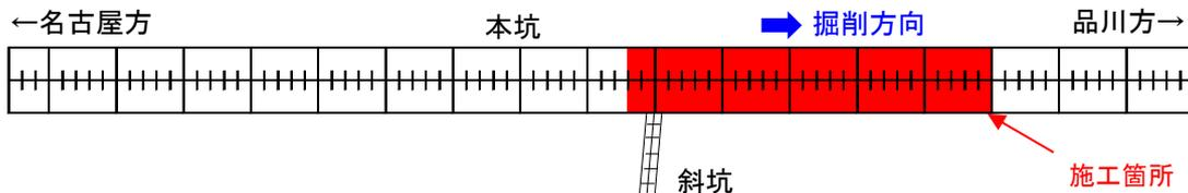
図-1 トンネル掘削進捗平面図（模式図）
