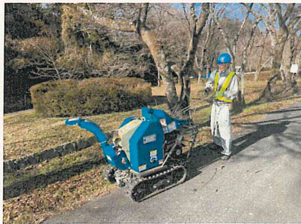
コバエ撤去 チッパー作業
